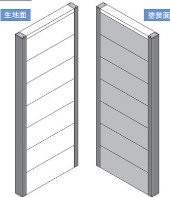
柱にベース材を取付け、PSパネルを差し込み、横棧を取付けます。
