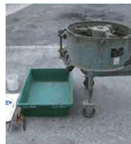
機械による練り混ぜ (使用量が多い時)
