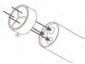
ライトの3つのLEDにフィルターのフレームが被らないように装着して下さい。フィルターの配置によって、色のついた影の出方が変わるので好みの位置に調節しましょう。
